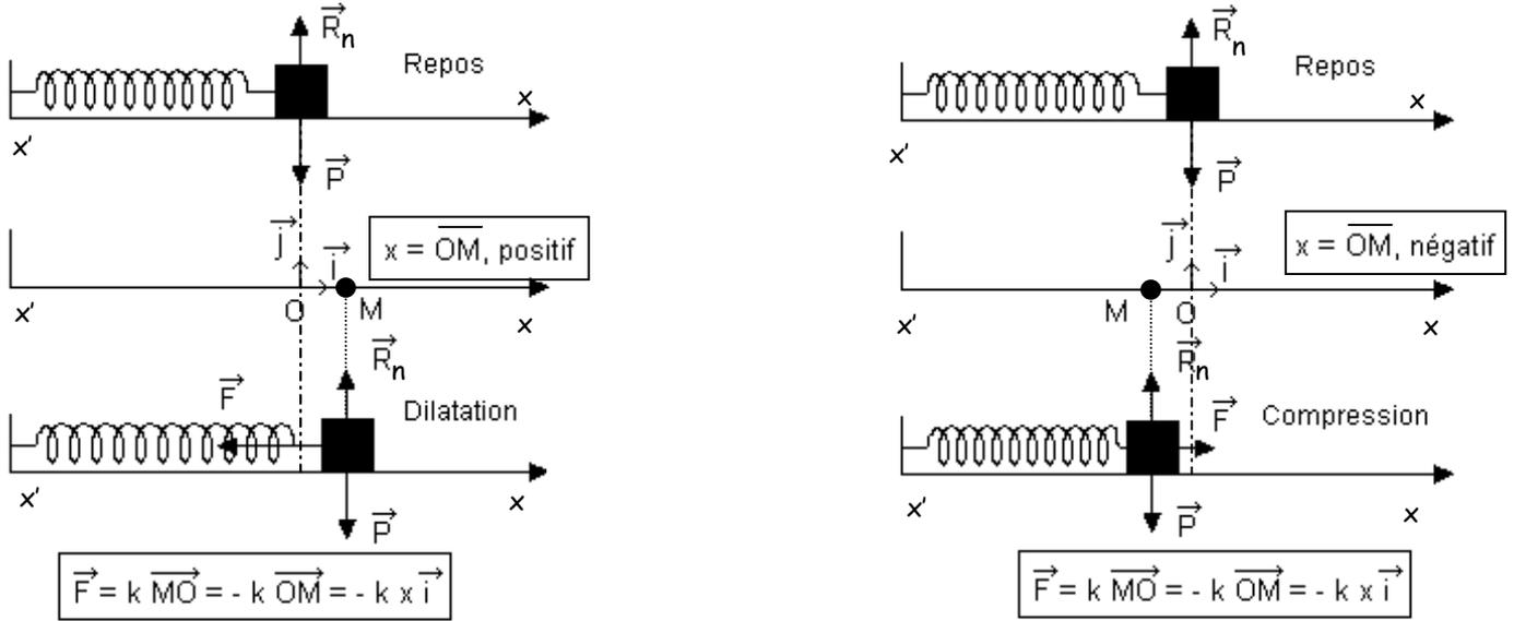
L'axe  $x'x$  est parallèle à l'axe du ressort (droite qui relie les centres des spires) orienté dans le sens de l'allongement de celui-ci (en général) et  $x = 0$  est pris à la position de  $G$  à l'équilibre (au repos).
